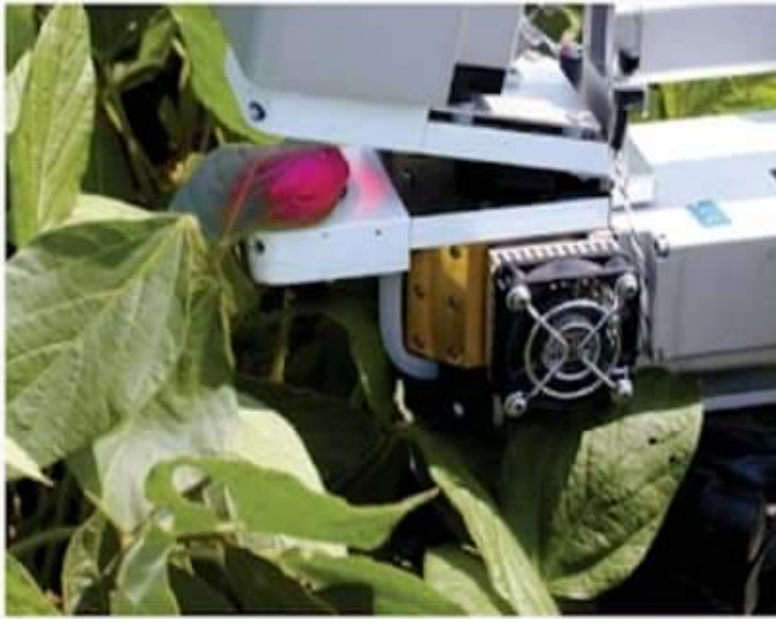
جهاز لقيس تأثير شدة الإضاءة على التركيب الضوئي
