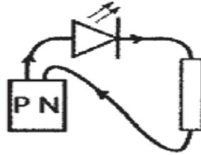
3) La diode LED s'allume cela signifie qu'un courant électrique la traverse donc le pôle P est le pôle positif.
