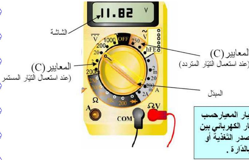
يقع اختيار العيار حسب جهد التيار الكهربائي بين طرفي مصدر التغذية أو المتقبل بالدائرة.
