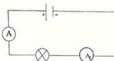
(1) إذا علمت أنَّ الأمبير متر A يشير إلى شدة تيار كهربائي قيمتها  $200\text{mA}$ ، حدد شدة التيار الكهربائي التي يشير إليها الأمبير متر  $A_1$  معللاً إجابتك
