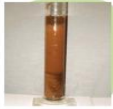
الوثيقة 42 : تجربة ترسيب المكونات الصلبة للتربة
