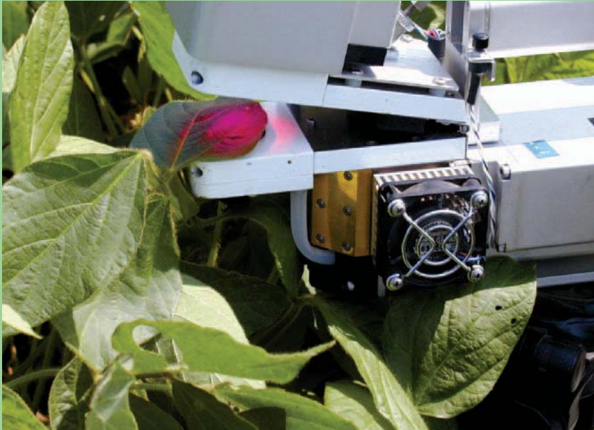
جهاز لقيس تأثير شدة الإضاءة على التركيب الضوئي
