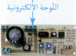
وحدة التغذية الكهربائية
