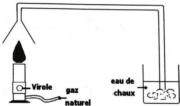
**Partie N°1 :** La virole du bec- benzène est fermée, j'observe un dépôt noir sur les parois internes de l'entonnoir et l'eau de chaux devient trouble.
