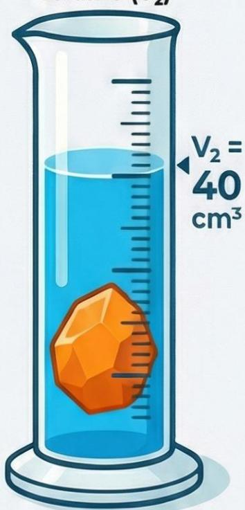
Plonger délicatement et entièrement l'objet solide dans l'éprouvette. Le niveau du liquide monte. Noter ce nouveau volume.
