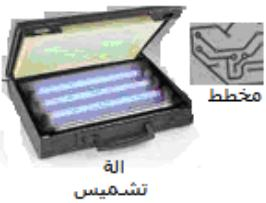
وضعية 2(أ): تشتعل الة التشميس بالطاقة الكهربائية وتصدر أشعة خطيرة.
